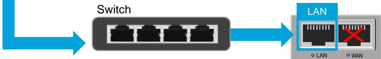
**i** Sollten mehr Endgeräte als verfügbare LAN-Buchsen angeschlossen werden, kann auch der **WAN-Port** zusätzlich als **LAN-Port** eingerichtet werden:
